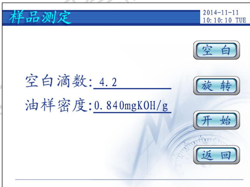
需要注意的是首次添加萃取液需要对萃取液进行空白滴定。具体操作步骤为将一干净的样杯放入样品盘任意位置，点击空白键开始对萃取液进行空白滴定，界面显示如下：
