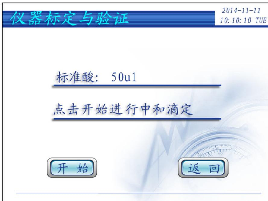
直接点击“50u1”处弹出键盘可更改注入标准酸的体积，注入标准酸点击开始进行中和滴定(与仪器标定相同)，中和滴定结束后，仪器进入如下界面：
