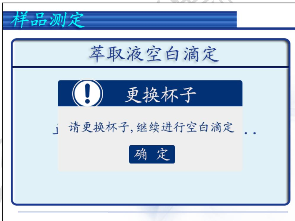
将带有废液的样杯替换为干净的样杯，点击确定开始抽取 20ml 萃取液，此步骤是通过抽取两次 10ml 萃取液实现的，抽取完成后萃
