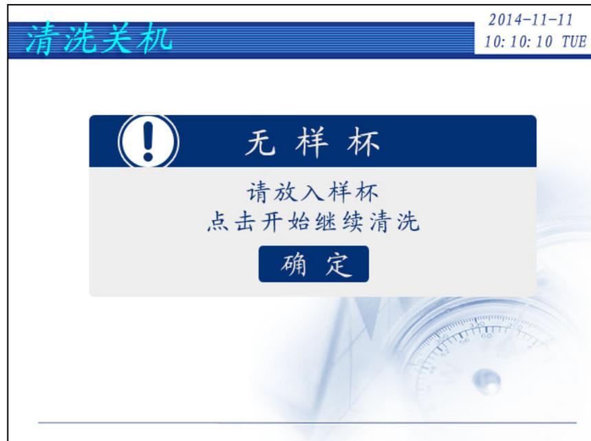
在样品盘二号杯位处放置一个废液杯，点击确定，仪器继续清洗，仪器开始自动清洗管路使其返回仪器开机初始状态，清洗完毕，关闭电源。取出试样杯，洗净烘干。打开仪器后盖，把蠕动泵上部的软管压臂松开，关闭后盖。
