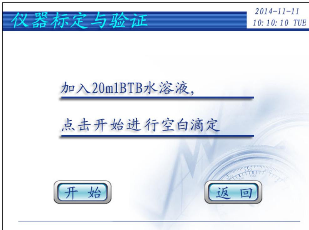
按照界面提示，用移液管准确吸取 BTB 水溶液 20ml（详见第三章 BTB 水溶液配制），放入样杯并将样杯放置于任意位置，点击开始，对含 BTB 水溶液进行空白滴定。界面显示如下：
